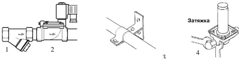
1. Перед монтажом клапана трубопроводы должны быть прочищены, т.к. попадание в клапан инородных частиц может привести к выходу его из строя. Перед входным отверстием соленоидного клапана необходимо установить фильтр-грязевик.
