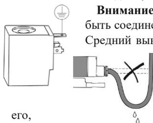
**Внимание! Без заземления не подключать!** Кабель заземления должен быть соединен с соответствующей клеммой. Катушка имеет три вывода. Средний вывод должен использоваться для заземления. Для катушек с выводным кабелем это провод желто-зеленого цвета. Два других вывода используются для подключения фазы и нейтрали источника питания. Прежде чем включить соленоидный клапан в работу, рекомендуется проверить подачу на него электропитание. Должен раздаться
